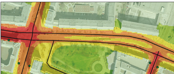
Analyse der räumlichen Verteilung der Konzentration im Nahbereich eines Hot Spots mit LAS arc
